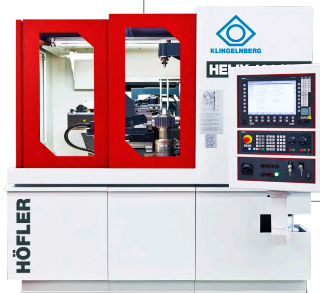
Höfler Stirradschleifmaschine HELIX 400 mit ergonomisch durchdachter Einhausung
