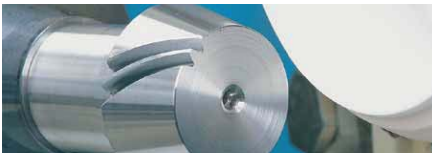
Schleifen eines Ritzels aus dem Vollen
