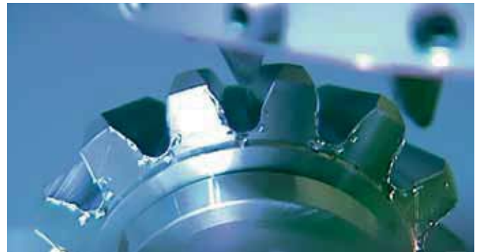
Bild 5: Im Hypoflex®-Verfahren gefräste Kegelradverzahnung
