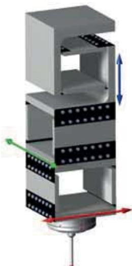
Bild 4: Schematische Darstellung eines konventionellen 3D-Tast- systems mit serieller Kinematik
