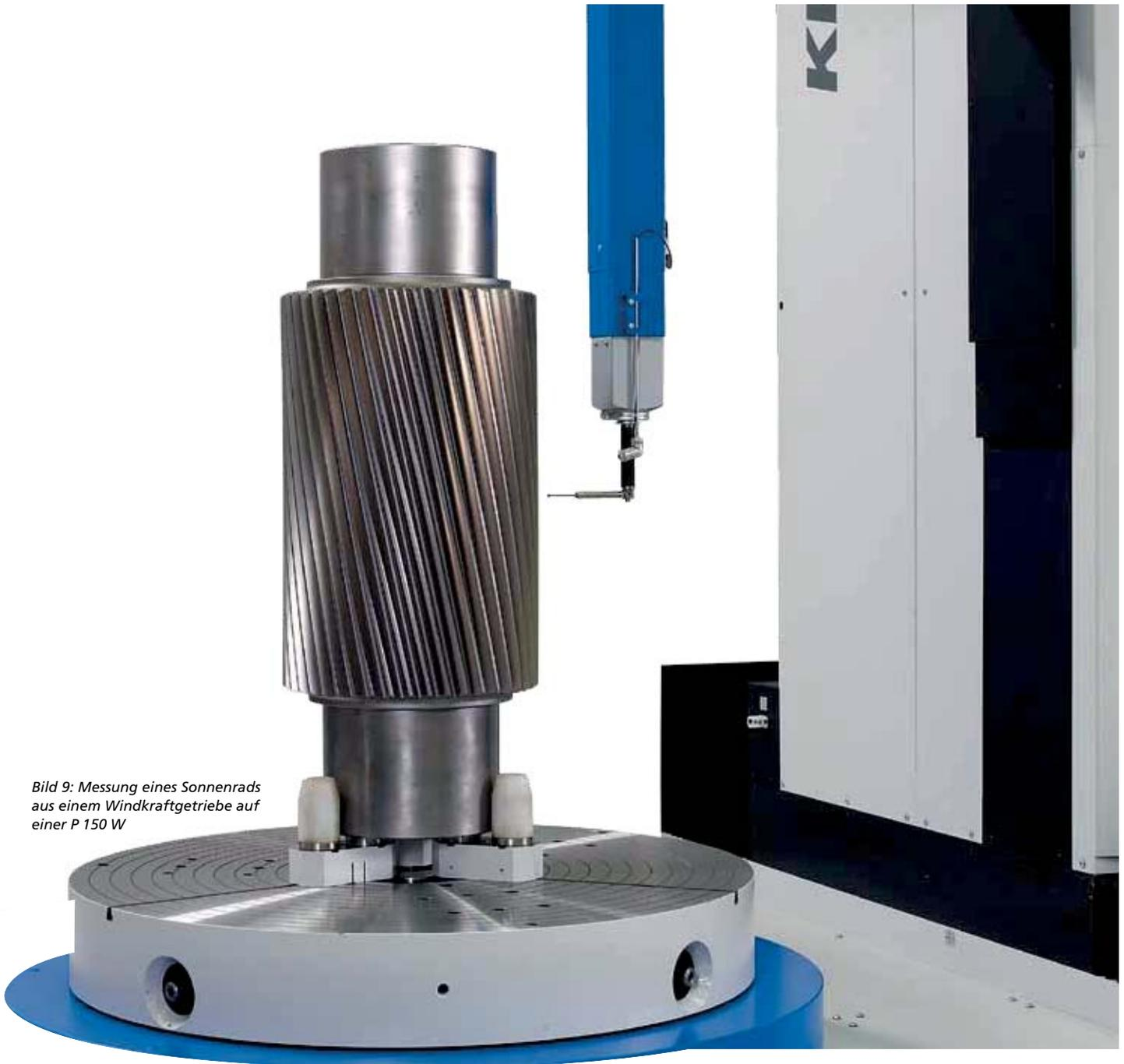
*Bild 9: Messung eines Sonnenrads aus einem Windkraftgetriebe auf einer P 150 W*
