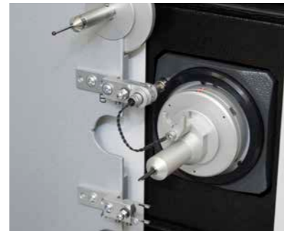
Automatisches Einwechseln inklusive automatisiertem Einsteckvorgang des Rauheitstastsystems.
