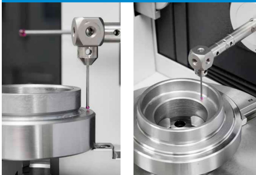
Abb. 8: Als Alternative zur Lehre kann auch direkt ein Präzisionsmessgerät eingesetzt werden.
